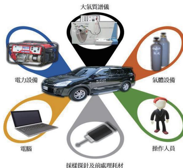
註：車載式大氣質譜儀之概念圖，包含一套大氣質譜儀、電力設備、氣體設備、電腦、採樣探針及前處理耗材、和操作人員。
