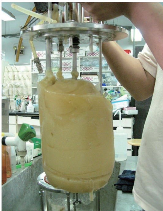
圖二 利用饋料批次操作結合菌絲形態控制策略生產高濃度靈芝多醣發酵液
