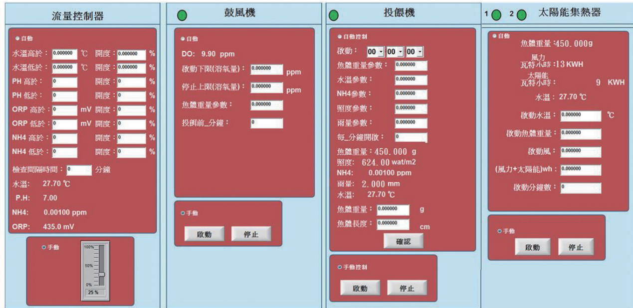
圖四 InduSoft圖控軟體邏輯掣動設定畫面
