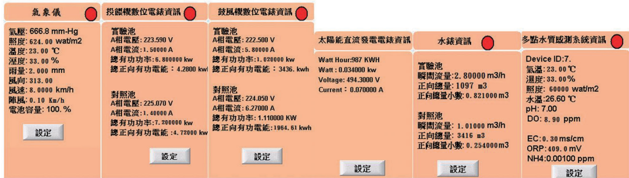
圖三 InduSoft圖控軟體各子系統參數即時監測畫面
