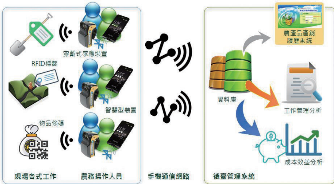
圖一 植基於物聯網技術之農畜生產管理及產銷履歷資訊系統架構圖
