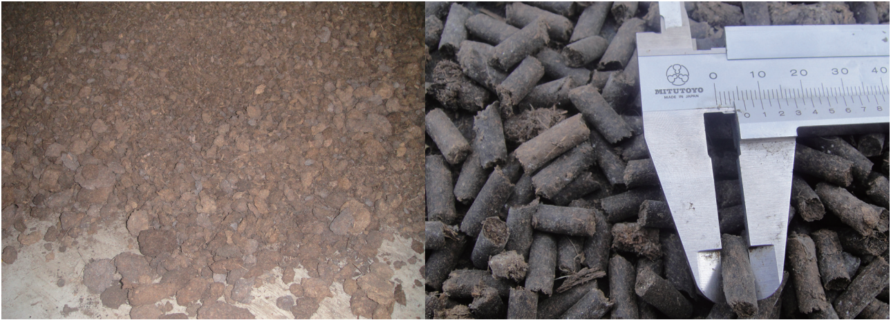
左：水車式固液分離之固形物乾燥產品；右：逕流式固液分離之固形物乾燥造粒產品。
