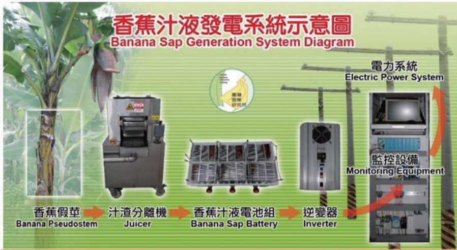
圖三 香蕉汁液發電系統示意圖（左）及可供手機充電之原始手電筒(右)
