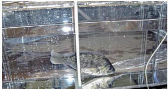
圖五 環形水道動態讀取測試平台（左圖）及吳郭魚活體通過水中感應線圈之情形（右圖）
