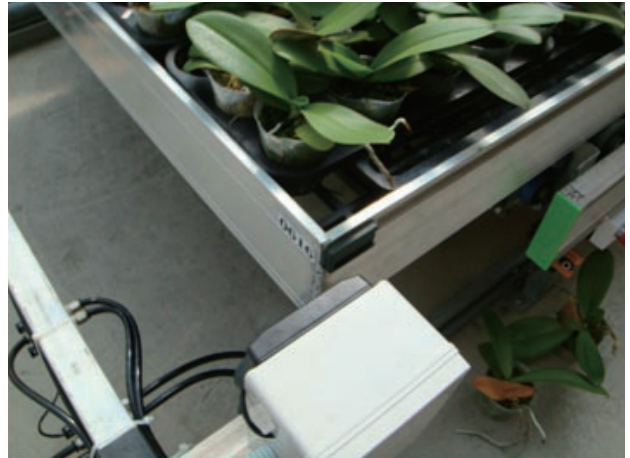
圖八 應用RFID於蘭花盤床定位管理
