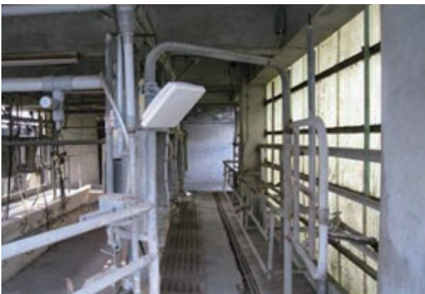
圖十 牛舍擠乳間入口前走道設置RFID Reader柵門
