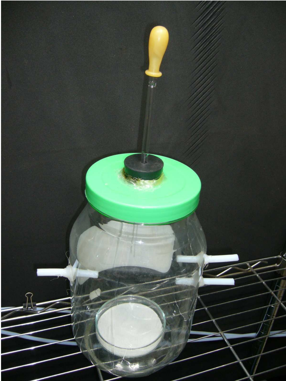
圖二、苯的產氣設備，苯液體由桶蓋上橡膠塞滴入，在濾紙上定量揮發為苯蒸氣，再以幫浦將氣體送出。
