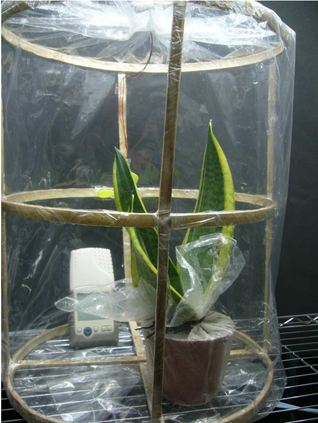
圖一、PP 材質熏氣箱，容積約 52 公升，附小型電風扇作為氣體攪拌之用。
